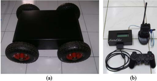
Gambar 9. Hasil Alat Penelitian (a) Robot Penjelajah, (b) Perangkat Pengendali
