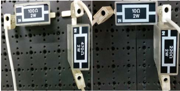
Gambar 4 Rangkaian Pembagi Tegangan di V_{cc} dan V_{ee}
