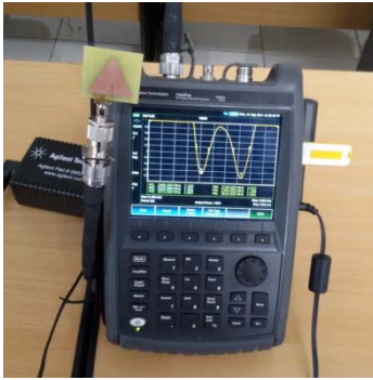
Gambar 22. Pengukuran Port Tunggal Menggunakan Network Analyzer Agilent.
