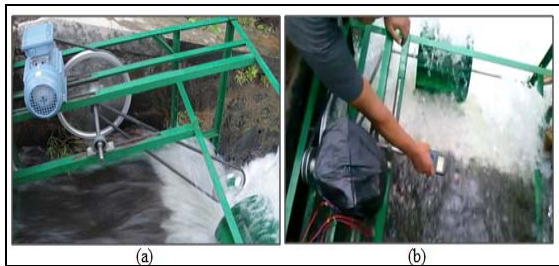
Gambar 10. (a) Transmisi Mekanik Speed Increaser 2 Rangkaian Dan (b) Pengujian Speed Increaser .
