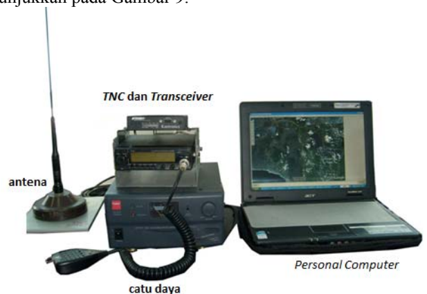
Gambar 9 Penampang fisis stasiun penerimaan paket data berbasis APRS
