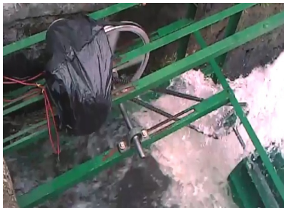
Gambar 4.11 Pengujian PLTPH Di Saluran Irigasi.
