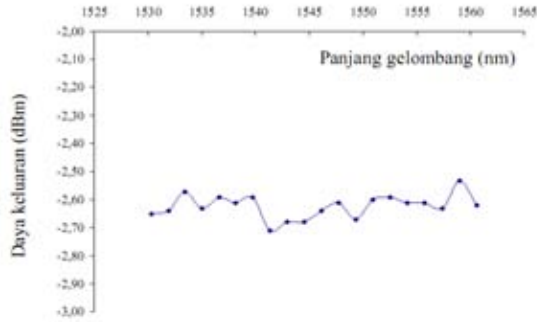
Gambar 4.4. Hasil Karakterisasi Level Daya Sinyal Yang Telah Melewati WDM Coupler
