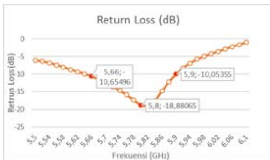
Gambar 5 Grafik Pengukuran Bandwidth Antena Helix 3
