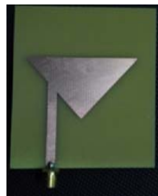
Gambar 10. Fabrikasi antenna mikrostrip tunggal bentuk segitiga terbalik [2]
