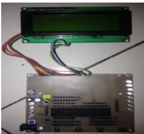
Gambar 10 Penempatan dan pemasangan komponen pada board untuk sistem mikrokontroler
