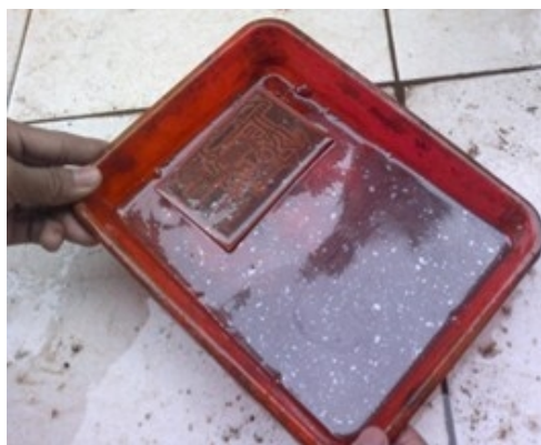
Gambar 11 Proses perlarutan terhadap lempengan PCB
