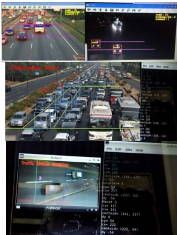
Gambar 7. Percobaan deteksi pada dua area jalur (lane) berbeda yang bisa di atur (atas), deteksi Kondisi Kemacetan (tengah) dan kondisi lancar (bawah) pada scene lalu lintas yang berbeda
